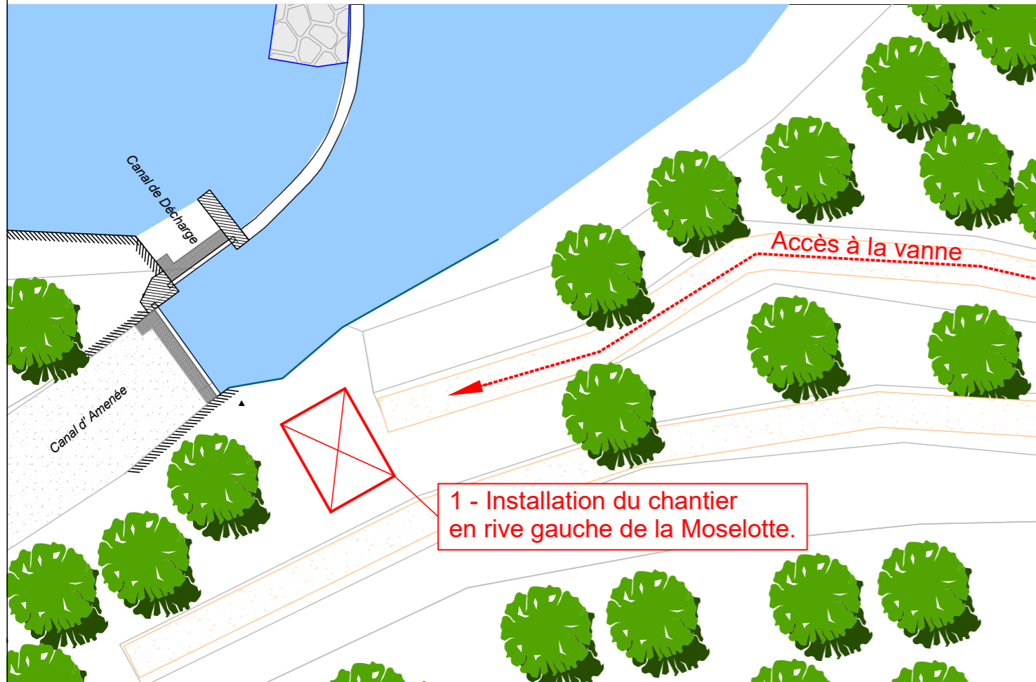
Phase 3 - Travaux de réparation du vannage
